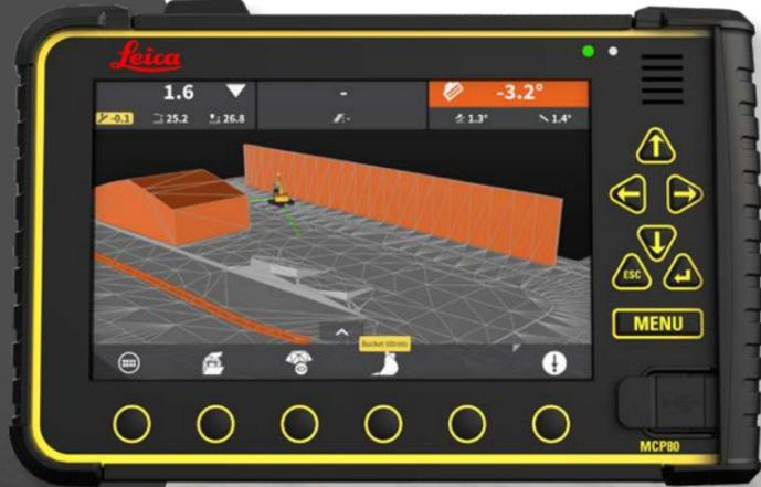
Sobald die Lösung die Maschine gestoppt hat, gibt die Leica MC1-Software eine visuelle Warnung aus, die bestätigt werden muss, bevor weitere Arbeitsvorgänge möglich sind.
